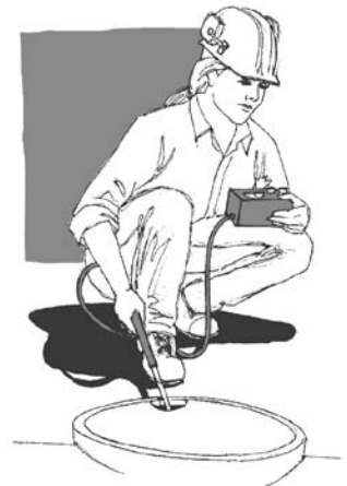
Thử độ dưỡng khí trong không khí bằng máy theo dõi dưỡng khí trước khi quý vị vào một chỗ bí bưng.
