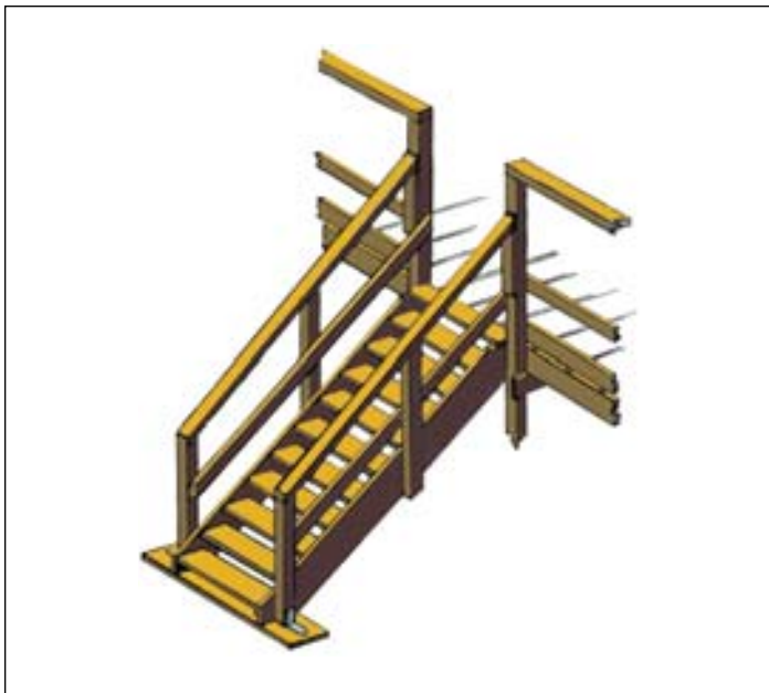
Escaleras provisorias con pasamanos.
